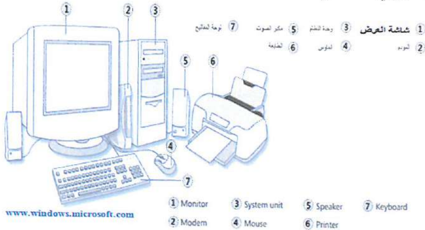
الشكل (1-2) يبين الأجزاء والملحقات الرئيسية للحاسوب المكتبي
